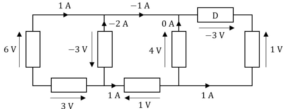
2) Le dipôle D est orienté en convention récepteur. La puissance calculée est donc une puissance reçue :
