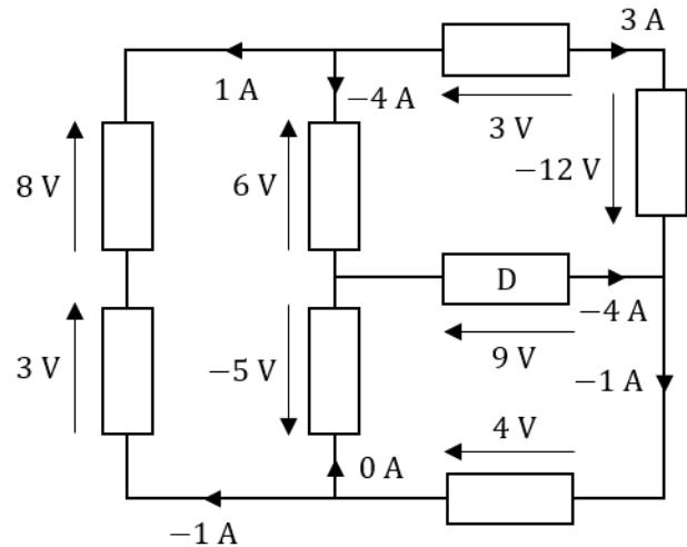
2) Le dipôle D est orienté en convention récepteur. La puissance calculée est donc une puissance reçue :
