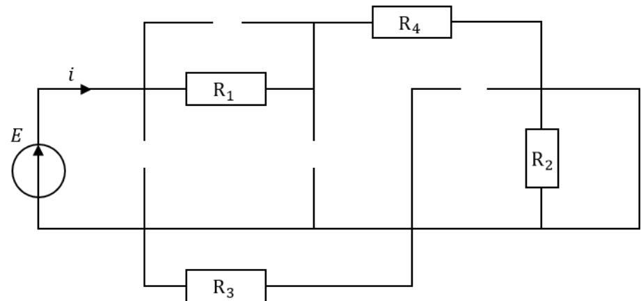
Les résistances  $R_2$  et  $R_3$  sont court-circuitées. Le schéma équivalent est donc :
